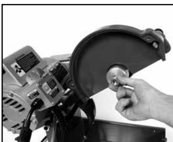
(D) Remove the retaining nut.
